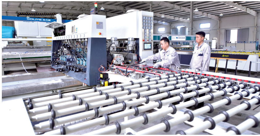
理大科技自主研发的连续式真空玻璃生产线
