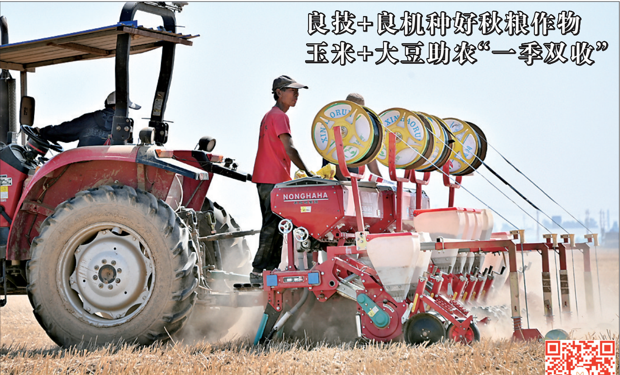
6月9日，浚县新镇镇杜村行，农机手驾驶着大豆玉米带状复合种植一体播种机在田间作业。这套设备能根据设定好的行数和间距，由北斗导航提供精准定位，自动完成玉米、大豆两种作物的播种，还能同步完成滴灌带的铺设，方便后期灌溉追肥，更加节水、节肥、省工、高效。
