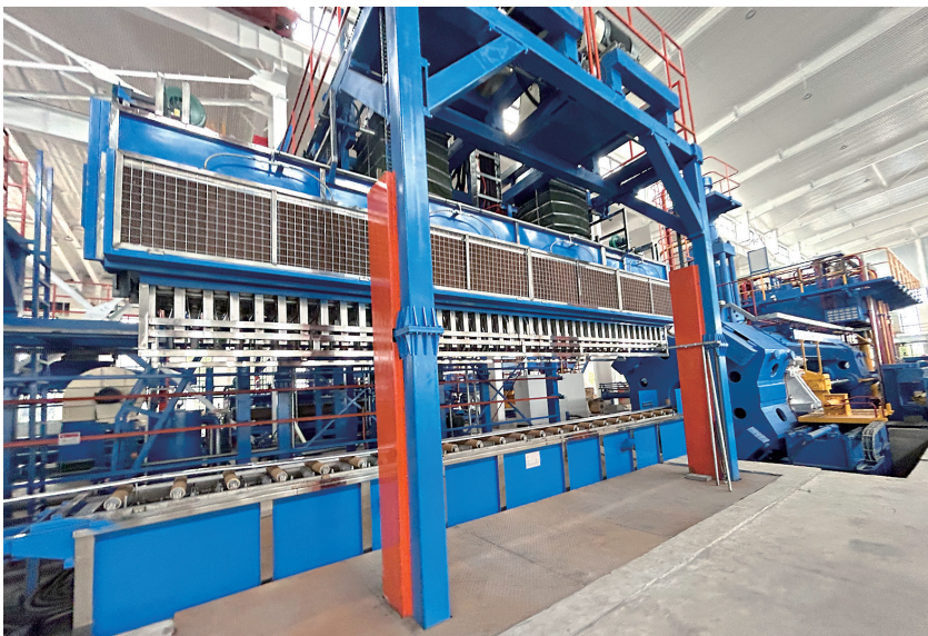
国内银行业新设备首台套6000吨大型挤压机在鹤壁经济技术开发区的明镁镁业试运行成功,标志着我市镁基新材料加工能力取得重大提升。
