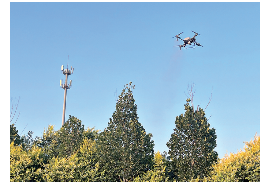
8月1日，在大白线附近的林带中，一架植保无人机对连片林木精准喷洒药剂，防治美国白蛾。 本报记者 马龙歌 摄
