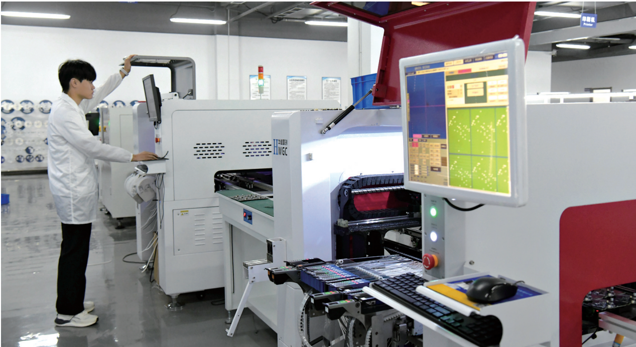
鹤壁中消云物联网科技有限公司的生产车间里,工作人员正在贴片机上作业。该车间能生产多种传感器,助力智慧消防建设。
