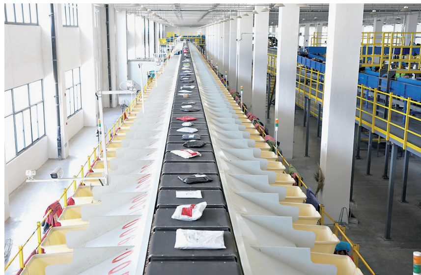
鹤壁快递村村通产业园分拣中心里，来自圆通、中通、申通、韵达、极兔、菜鸟等6家快递公司的包裹在高速传送带上接受智能摄像头的精准扫描，自动分拣后落入对应格口，平均每分钟分拣处理300余件包裹。
