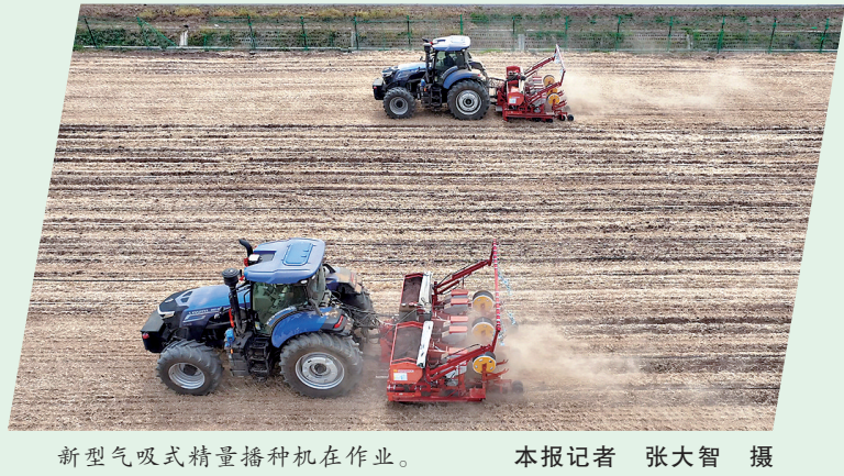
新型气吸式精量播种机在作业。 本报记者 张大智 摄
